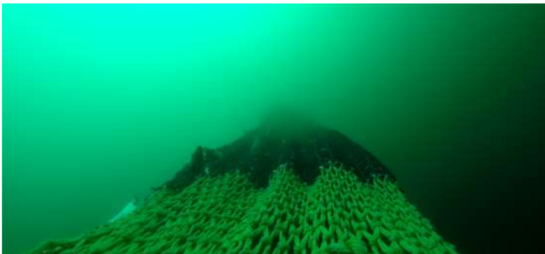
Kvadratmaskesekk med forlengelse. Kameraet er plassert foran sekken og filmer bakover.
