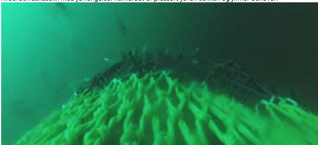
Kvadratmaskesekk uten forlengelse. Det virker som de gule diamantmaskene er mer utspilt når forlengelsen er fjernet, men fremdeles ujevn form på selve kvadratmaskesekken.
